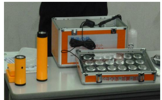
水に浸すと発電する水電池
